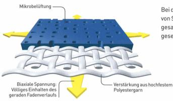
Bei der weltweit patentierten Précontraint Technologie von Serge Ferrari® wird der Verbundstoff während des gesamten Herstellungsprozesses unter Spannung gesetzt.
